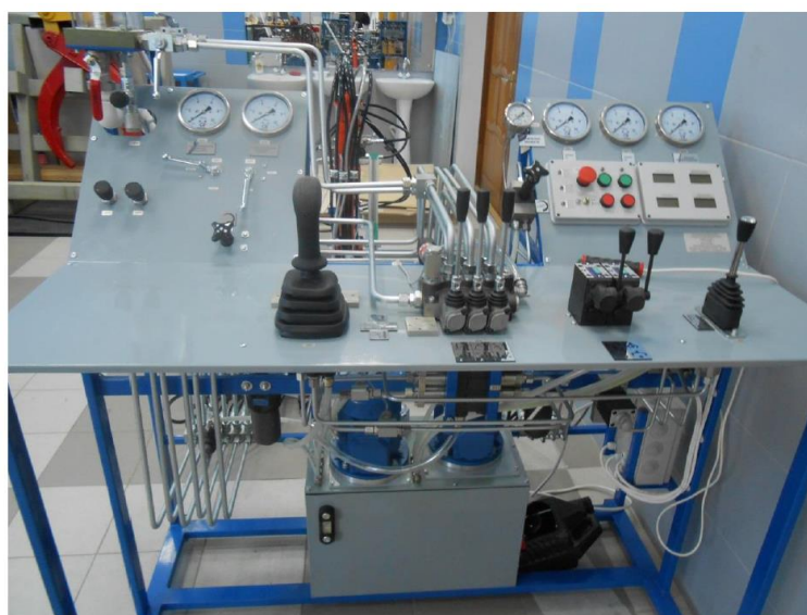
Рис. 3 Пульт управления установкой для исследования РВД
