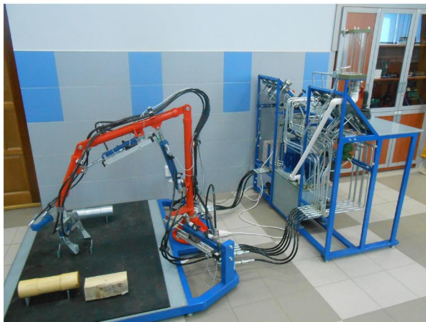
Рис. 2 Внешний вид стенда для исследования РВД
