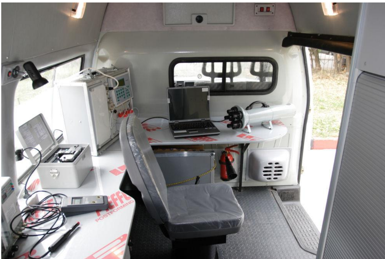
Рис.1. Передвижной экологический пост контроля атмосферы
