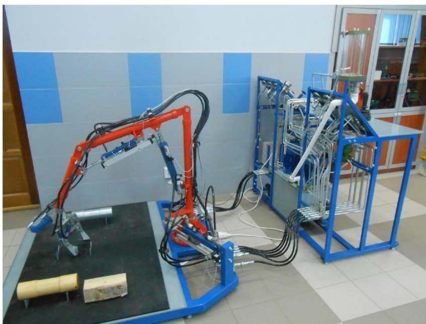
Рис. 2 Внешний вид стенда для исследования РВД
