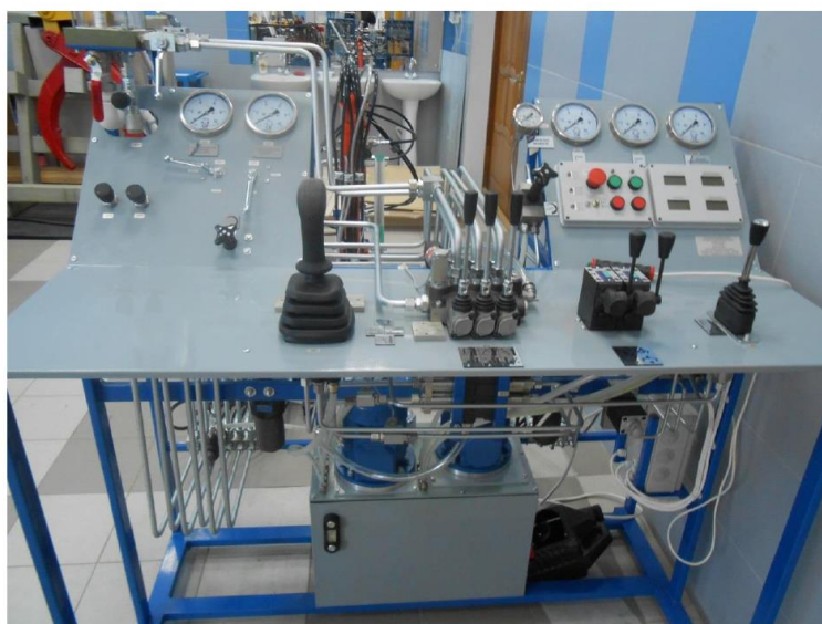
Рис. 3 Пульт управления установкой для исследования РВД
