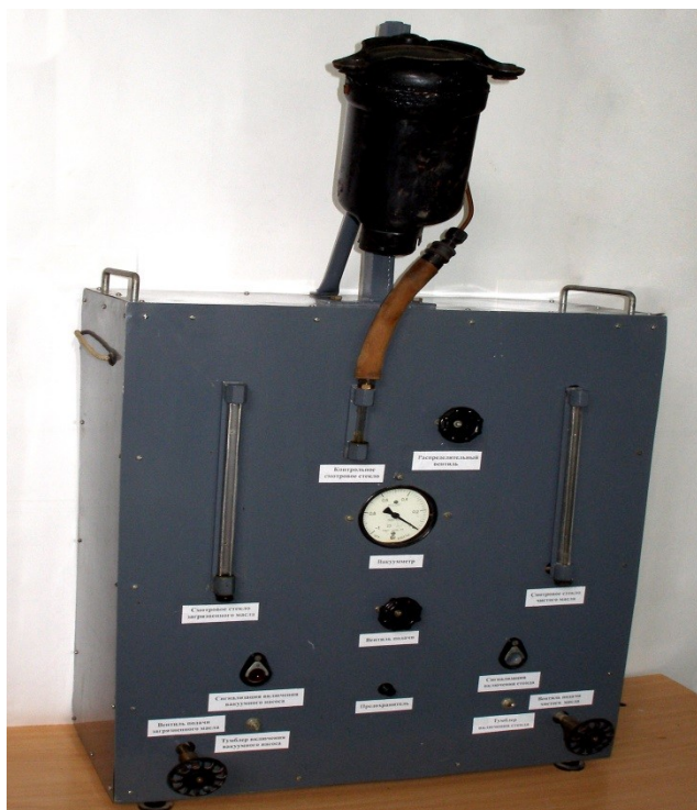
Рисунок 1.2. Установка для регенерации холодильного масла
