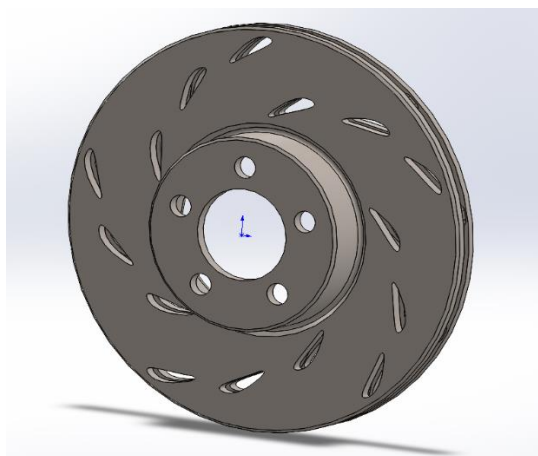
Рисунке – 4. Обычный тормозной диск с каплевидными перфорациями
