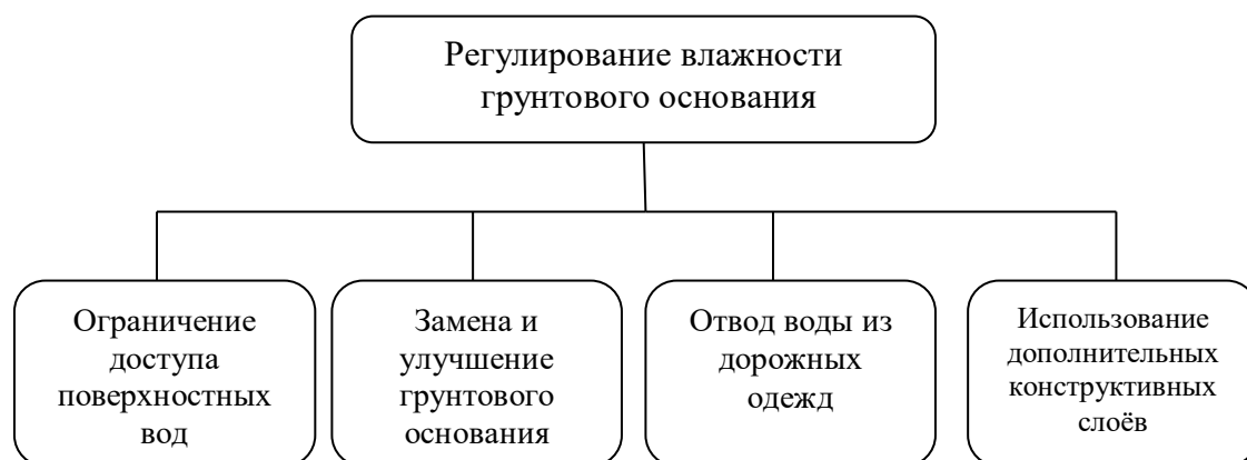
Рисунок 1 – Методы регулирования увлажнения грунтового основания
