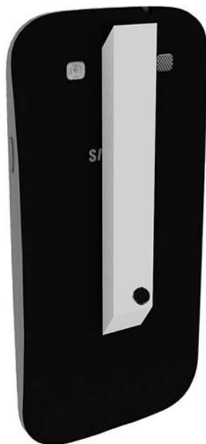
Рис. 3. Мини-спектрометр укрепленный на смартфоне
