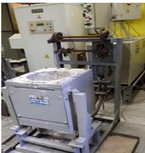
1-rasm. Induksion tigel pechi
