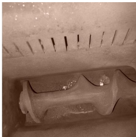
Рисунок 2 – Шнековая подача угля в топку
