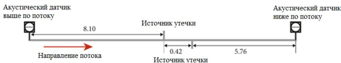
Рисунок 2. Принцип локализации течи на акустическом методе [22]
