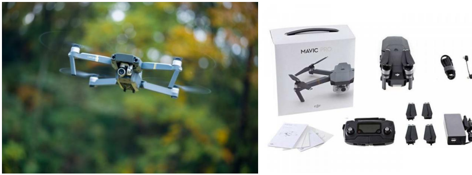
Рисунок 1 – БПЛА DJI Mavic Pro (слева – в полете, справа – БПЛА и его комплектующие)
