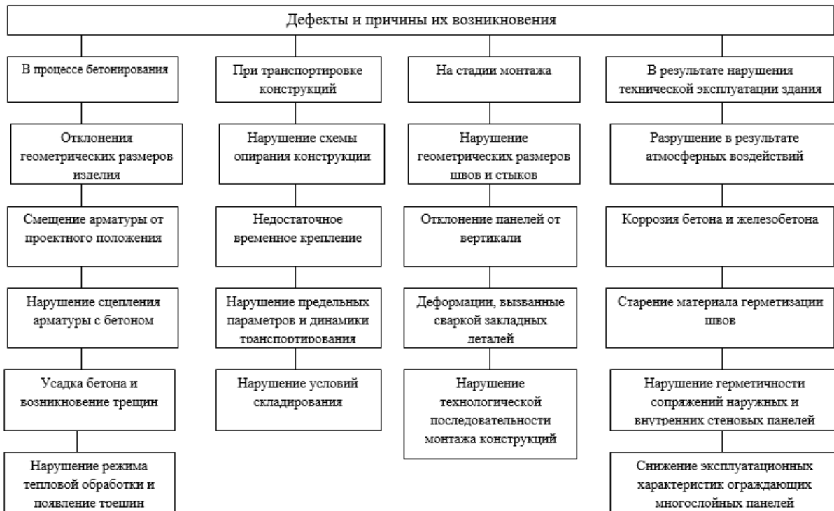
Рисунок 1 – Причины возникновения дефектов в здании после динамических нагрузок
