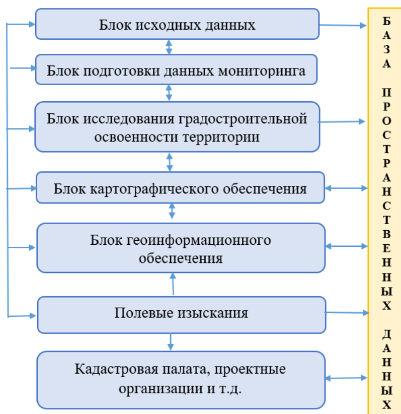
Рисунок 1. Принципиальная технологическая схема организации мониторинга земель сельских населенных пунктов
