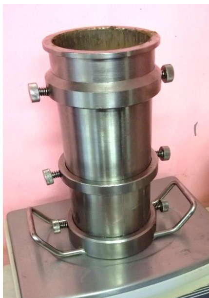
Рисунок 1 – Форма для прибора стандартного уплотнения с глинистым образцом
