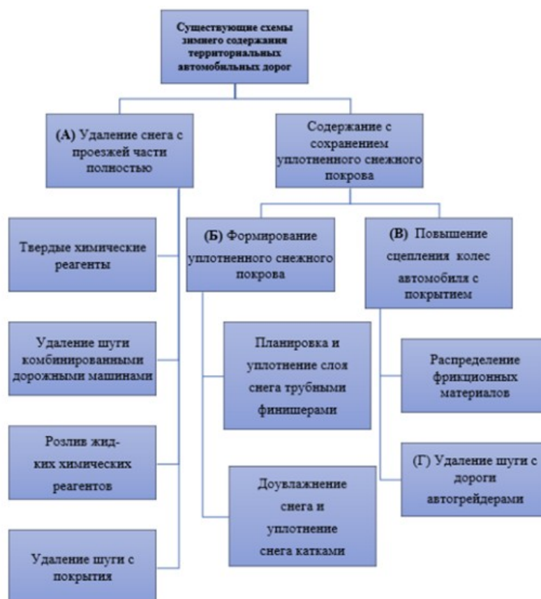
Рисунок 1 – Схемы зимнего содержания лесовозных автомобильных дорог применяемых в многолесных регионах
