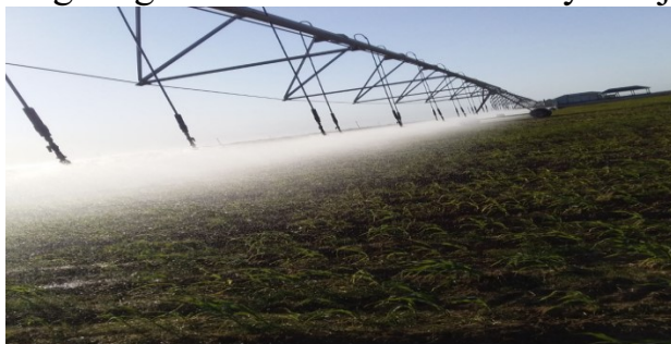
1-rasm. Markazlashgan pivotli sugo'rish tizimi texnologiyasi.
