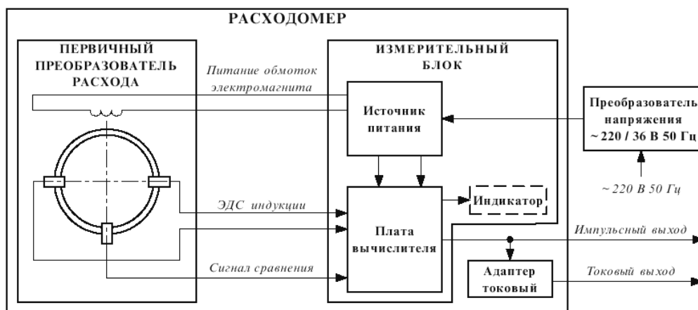
Рисунок 7 - Структурная схема расходомера счетчика электромагнитного «Взлет ЭР-510»
