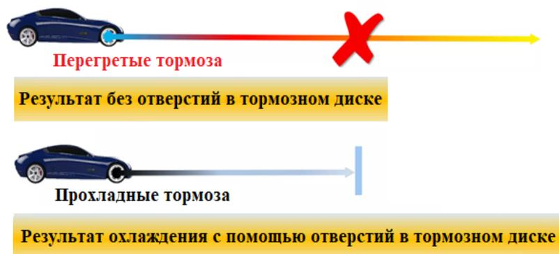
Рисунке – 5. Тормозной эффект перфорированного тормозного диска
