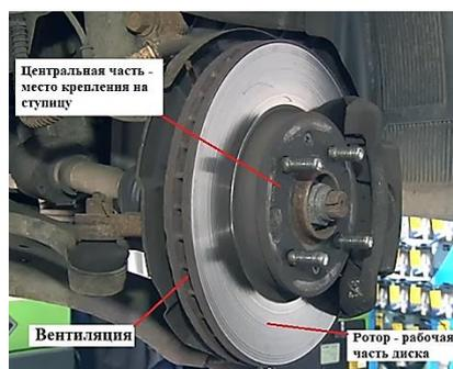
Рисунок 1. Обычный тормозной механизм.
