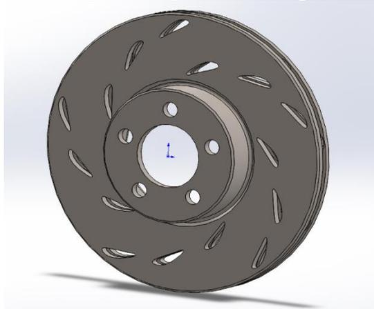
Рисунке – 4. Обычный тормозной диск с каплевидными перфорациями
