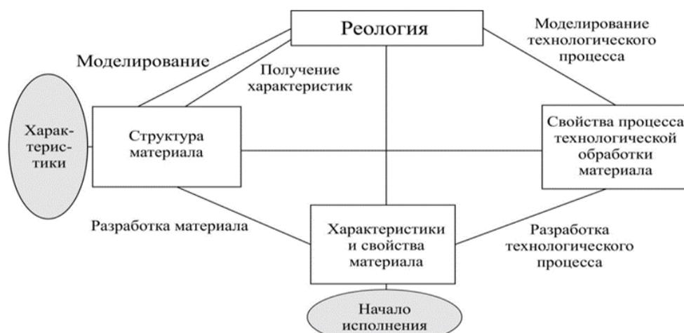
**Рис.1.** Диаграмма применения реологии для коррелирования характеристик конечного использования и технологической обработки полимеров.
