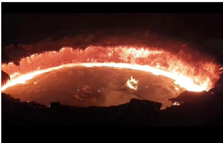
Расм - 1. Иссиқликни изоляция қилувчи аралашманинг суюқ металл юзасидаги кўриниши
