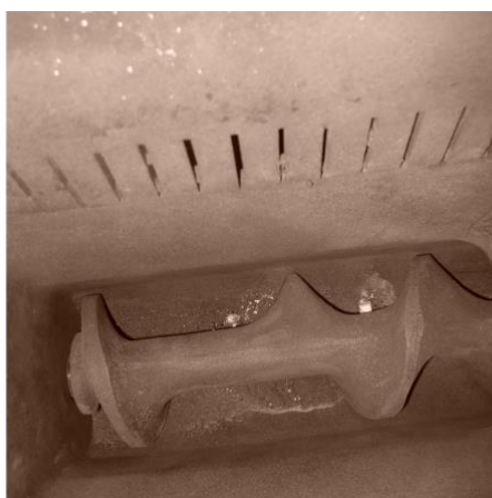
Рисунок 2 – Шнековая подача угля в топку
